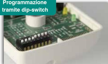
Programmazione tramite dip-switch
